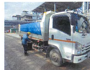
การปิดคลุมรถบรรทุกวัสดุก่อสร้างในการขนส่ง
